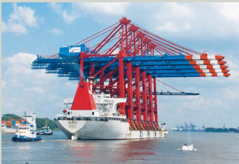
Modern und effizient: die 80 Meter hohen, neuen Containerbrücken für EUROGATE.
